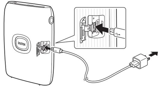
Verbinden Sie den Drucker über das mitgelieferte Mikro-USB-Kabel an einen USB-Netzadapter (im Lieferumfang Ihres Smartphones enthalten) an, und verbinden Sie anschließend den USB-Netzadapter mit einer Stromversorgung.
